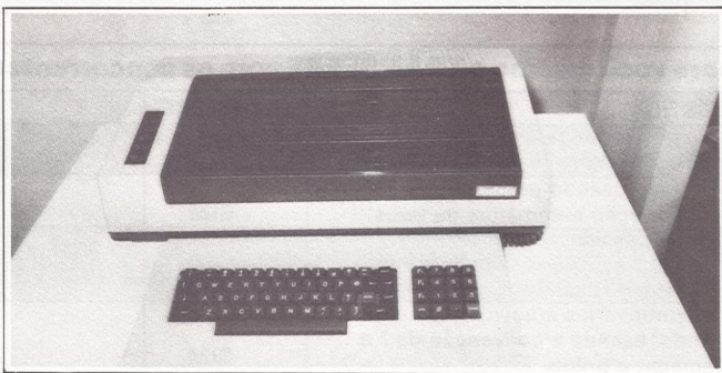
As teleimpressoras incorporam teclado profissional padrão máquina de escrever
